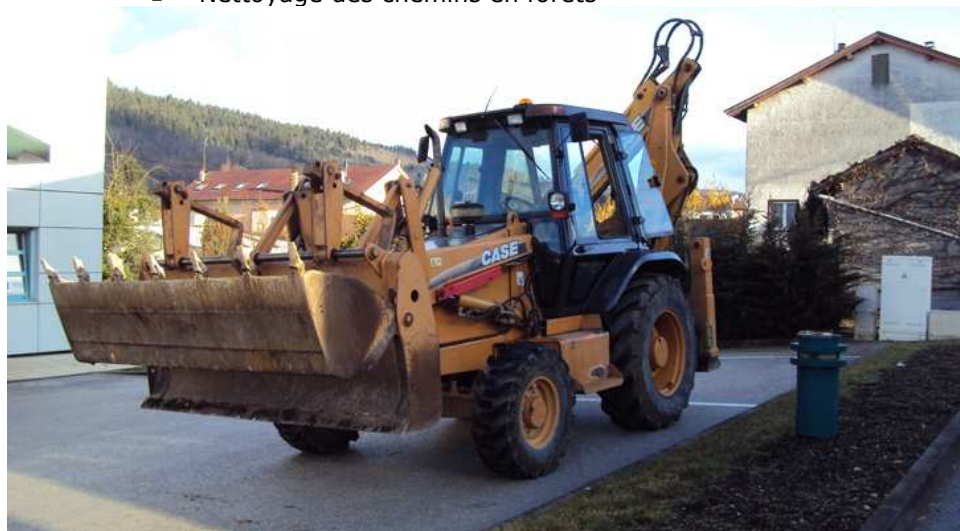
Engin CASE 580 SM équipé de fourches, godets de curage et de tranchée
